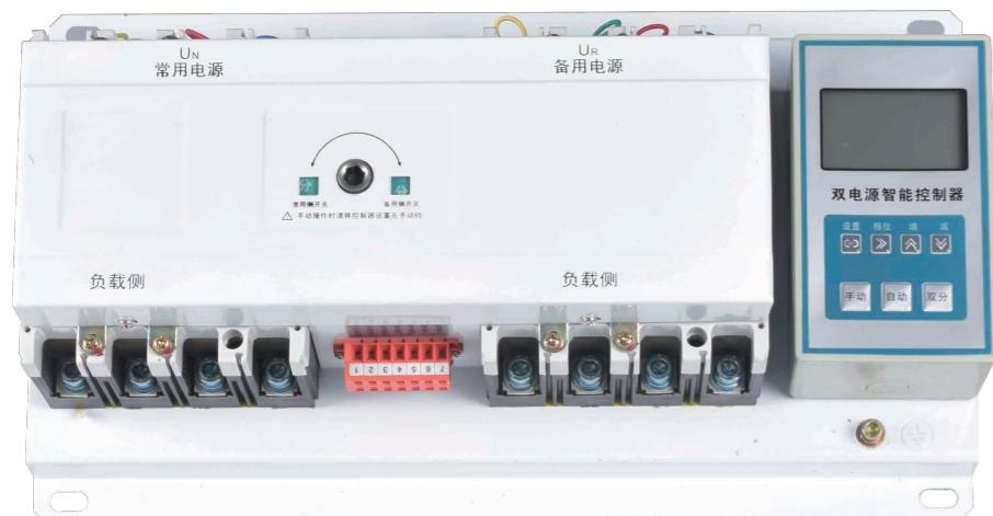
CSSW系列CB级智能双电源转换开关适用于交流50Hz,额定工作电压400V, 额定工作电流6A~630A。适用于紧急供电系统的两路电源常用电源(N)与备用电源(R)之间的互相转换(也可设定为手动)和作为控制、信号、联锁等用途的控制电路的开关, 本品在某些型号中带有通讯专口, 可实现远程控制, 让用户实现无人值守变电所。适用于住宅小区、军事设施、医院、商场机场等场所。
