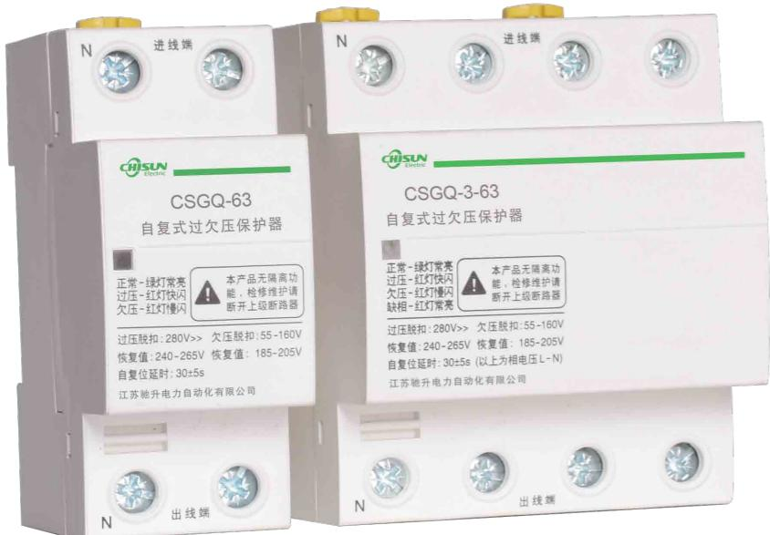
过欠压延时保护器(以下简称保护器)是根据目前市电状况开发的新一代家电保护装置。能在电压异常的情况下起保护作用，当市电电压超过或低于保护器动作电压值时，保护器能迅速、可靠地切断负载电源，以达到保护电器和人身安全的目的。当市电电压恢复正常时，保护器自动接通电源，恢复供电，实现全自动控制。面板上双色发光二级管指示保护器工作状态，指示灯发绿光是正常供电，发红光时保护功能启动切断供电。具有使用简单方便、性能稳定可靠的特点。产品结构紧凑、外形美观。
